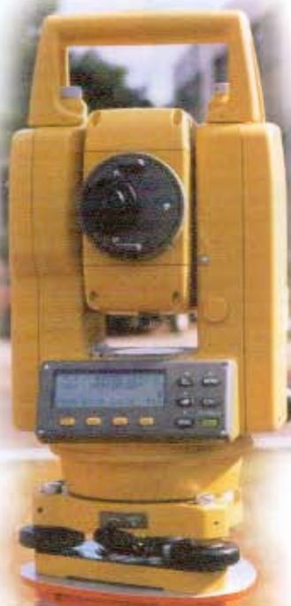
Detalhe da Estação total, para levantamento planialtimétrico
